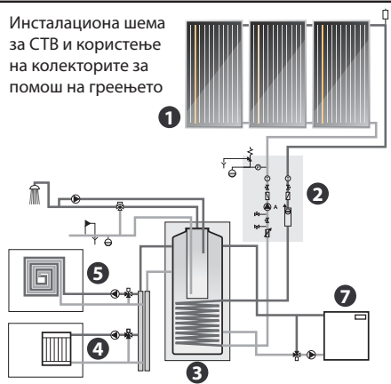
Инсталациона шема за СТВ и користење на колекторите за помош на греењето
