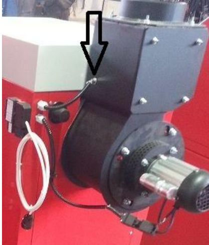
Slika 15. Položaj postavljene sonde
