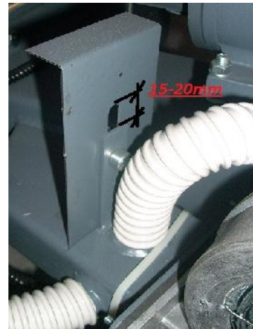
Slika 17. Položaj max. otvorene klapne vent.
