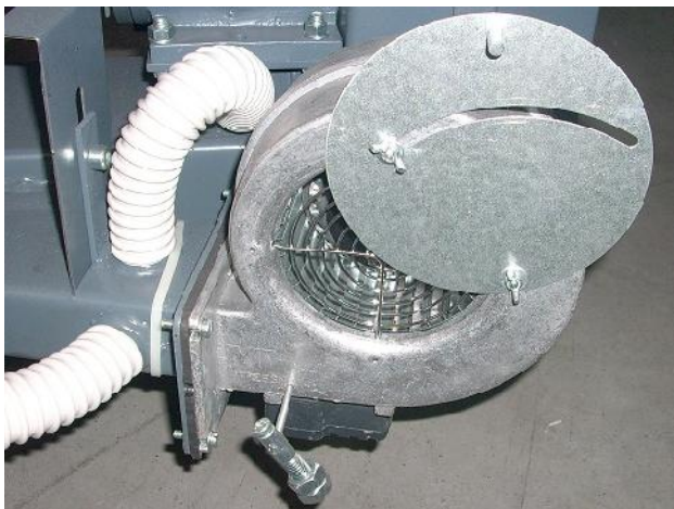
Slika 13. Položaj klapne ventilatora
