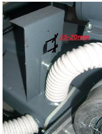
Slika 14. Položaj max. otvorene klapne vent.
