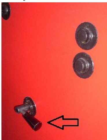
Slika 17. Položaj ručice klapne RADNI
