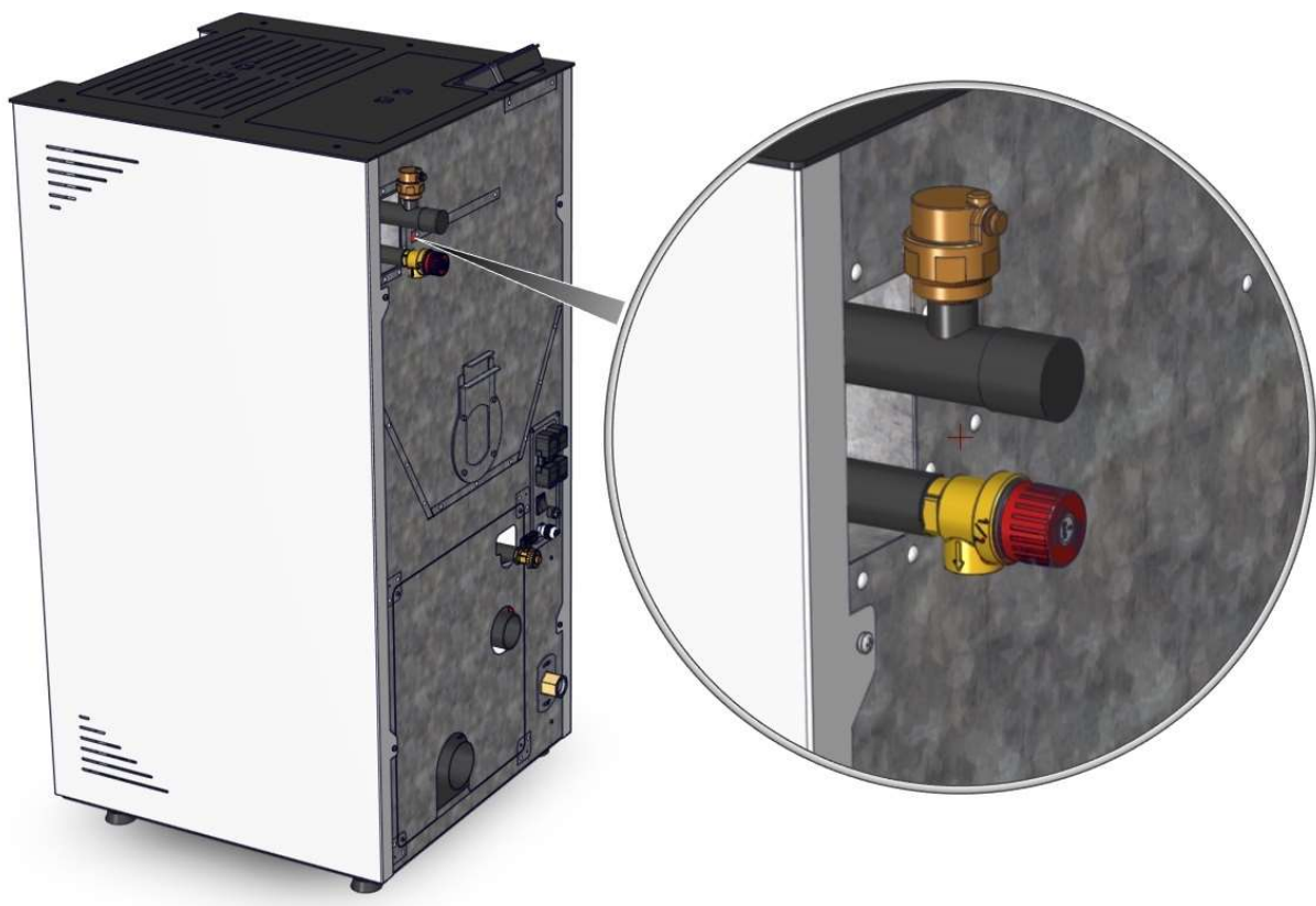
Slika 15. Prikaz odzračnog lončeta i sigurnosnog ventila na zadnjoj strani kamina
