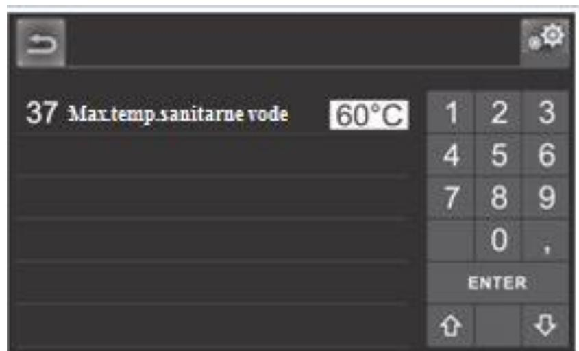
Pomoću tastature unosite željenu vrednost (npr. 60°C, kao na slici). Obavezna je potvrda uz pomoć ENTER.
