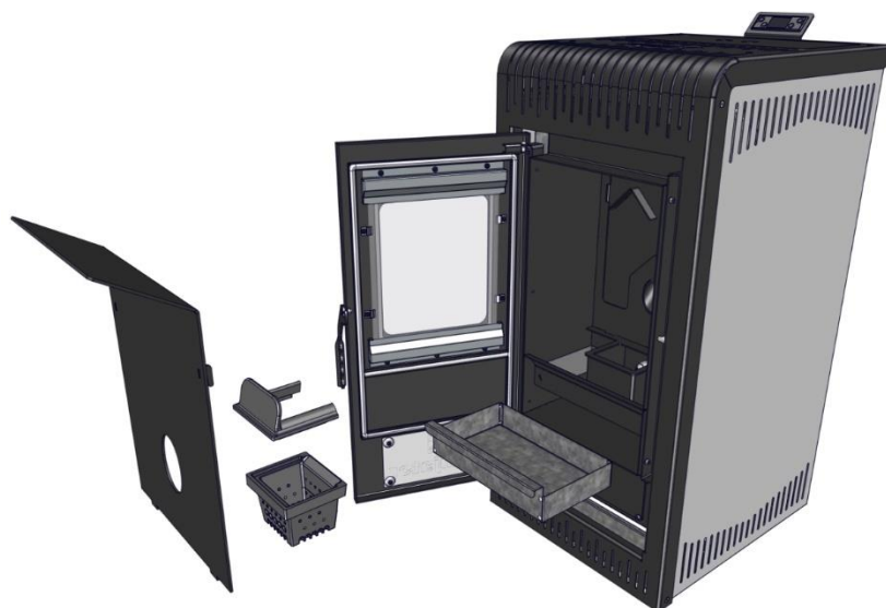
Slika 28. Čišćenje solje za sagorevanje i turbulatora
