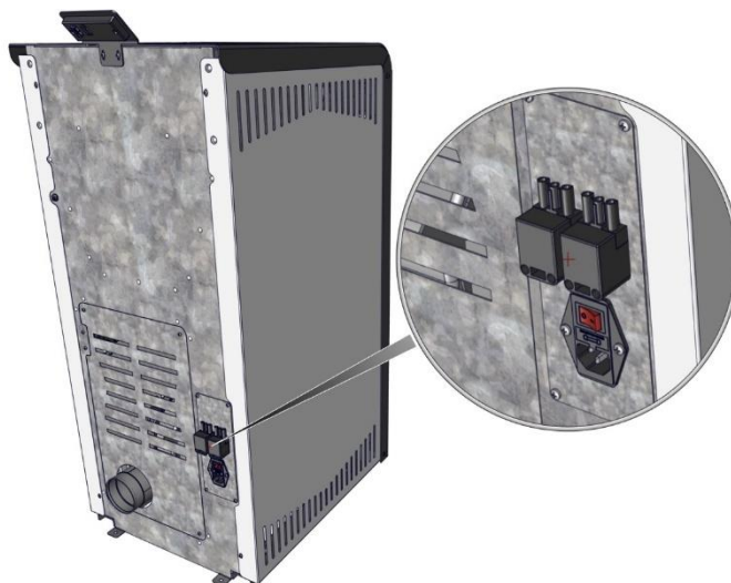
Slika 26. Prikaz pozicije kablovske uvodnice, glavnog prekidača kao i sigurnosnog termostata
